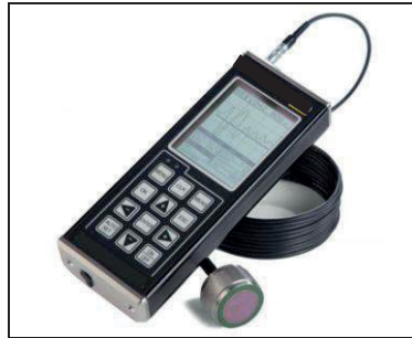
Fig. 7 - Strumento ad ultrasuoni per misura allungamento tiranti
